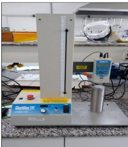
Figura 6 – Dinamômetro.
