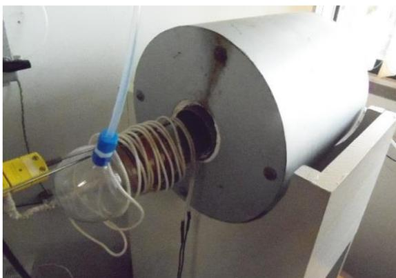
Figura 4 – Forno para tratamento térmico.
