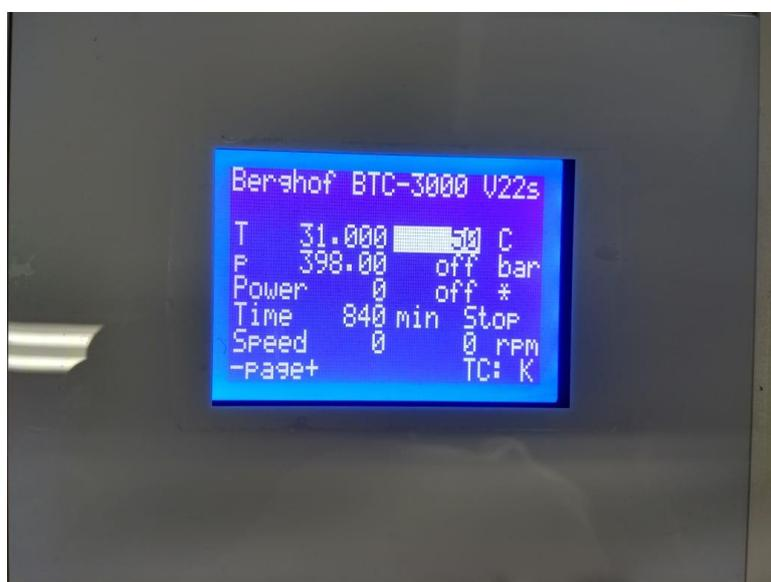
Figura 13 - Condições de operação da digestão ácida.
