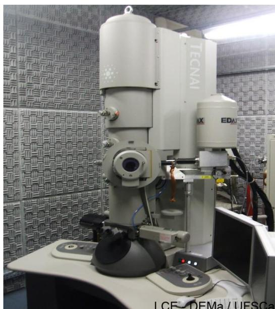
Figura 11 - Microscópio de Emissão Eletrônica.
